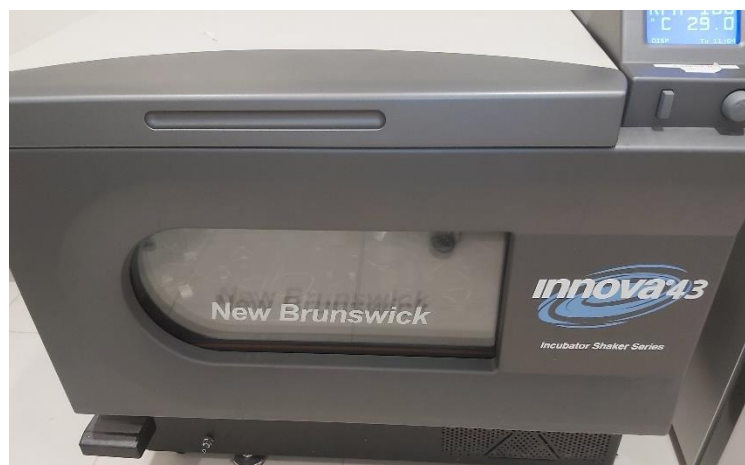
Figure 4: Incubateur à sec innova 43, incubator shaker series, New Brunswick, employé dans l'incubation bactérienne
