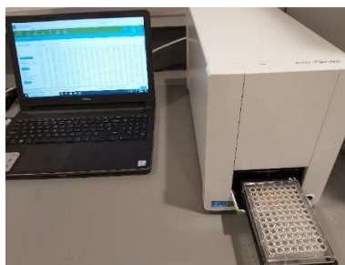
Figure 8: Lecteur des microplaques multimode, victor nivo, E-VICTOR-001, utilisé dans la mesure de la DO, pour le test de salinité sur milieu liquide
