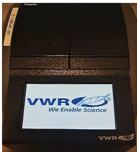
Figure 12: Thermocycleur VWR, E-THERMC-001, Doppio, utilisée pour la PCR
