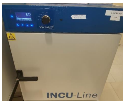
Figure 5: Etuve VWR, INCU-Line, E-INC56-002, employée dans l'incubation bactérienne
