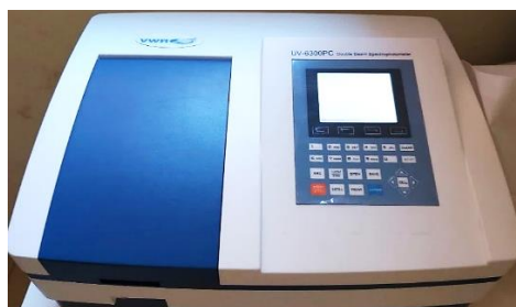
Figure 7: Spectrophotomètre UV-6300PC- Double beam spectrophotometer, utilisé dans la mesure de la DO
