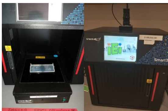
Figure 10: Transilluminator VWR, E-GELDOC-001, smart 3, servant à la visualisation du gel d'électrophorèse sous UV
