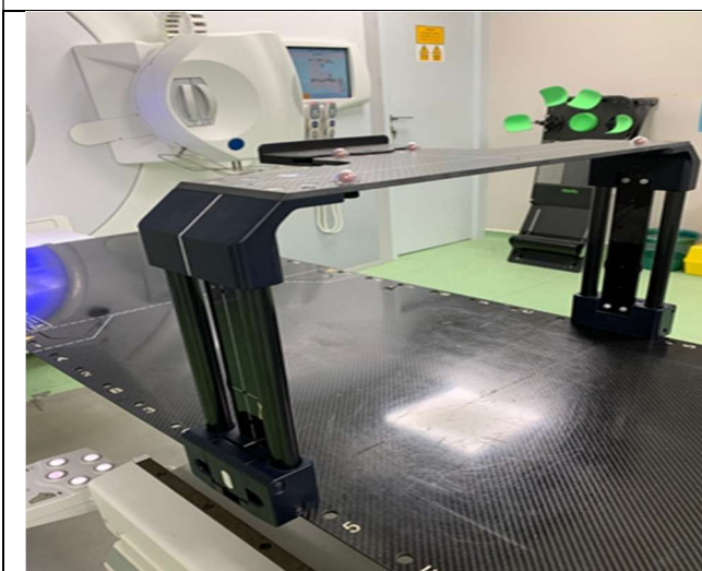
Cardre HexaPOD: Système de positionnement utilisé dans la salle de traitement, permettant de corriger d'éventuel décalage sous-millimétrique. Il effectue des déplacements de la table dans six degrés de libertés par l'intermédiaire de deux caméras infrarouges et du logiciel « Iguide » d'Elekta.
