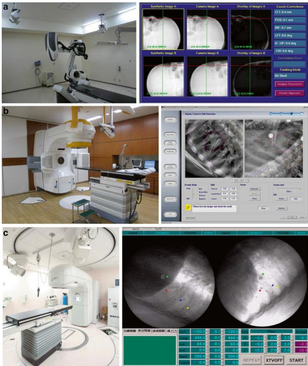
Fig. 7 Systèmes d'imagerie stéréoscopique 2D kV. (a) Le système CyberKnife. (b) Le système Novalis Linac avec le système d'imagerie ExacTrac. (c) Système de radiothérapie de suivi des tumeurs en temps réel
