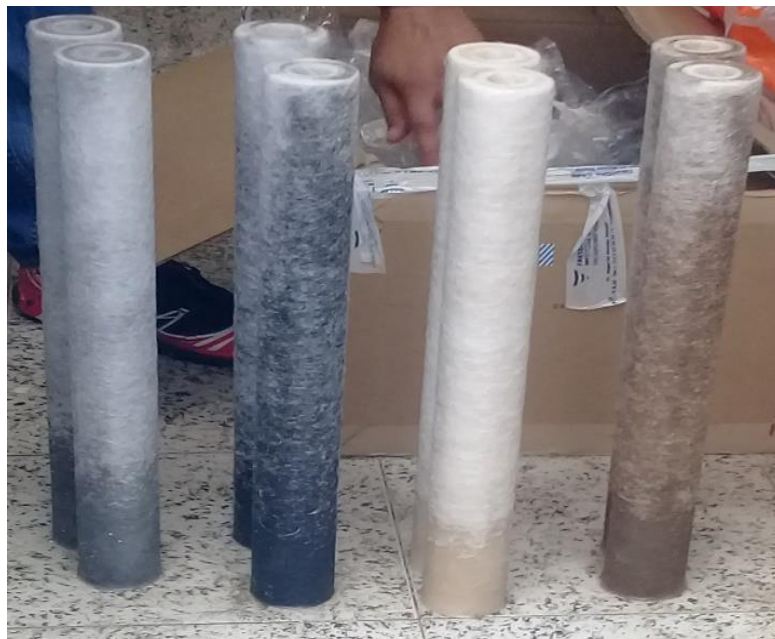
Figure 7 : Filtres changés après désinfection des raccords
