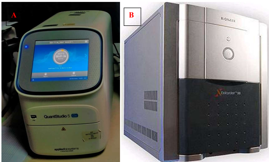
Figure 8: Deux thermocycleurs utilisés au laboratoire pour la RT-PCR MAScIR 2.0 : A : QuantStudio™ 5 DX Real-Time PCR System Applied Biosystems™ et B : Exicycler™ 96 Real-Time Quantitative Thermal Block (Bioneer™).
