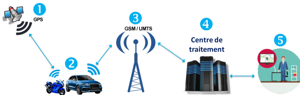
FIGURE 5.7 – Aperçu général des interactions entre les éléments du système pour la collecte de traces en temps réel.
