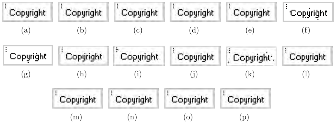
Figure 2.13 – Marques extraites après quelques attaques : (a) Marque insérée, (b) HE, (c) GN( \sigma = 0.001 ), (d) SPN , (e) LPGF (taille de fenêtre : (9 \times 9) ), (f) JPEG (Q= 60), (g) JPEG (Q= 65), (h) JPEG (Q= 70), (i) JPEG (Q= 75), (j) Lissage gaussien (taille de fenêtre : (9 \times 9) ), (k) Coupe 50%, (l) Coupe 25%, (m) HE+ SPN ( \sigma = 0.001 ), (n) GN ( \sigma = 0.001 ) + JPEG (QF= 90), (o) SPN ( \sigma = 0.001 ) + JPEG (QF= 90), (p) HE + GN ( \sigma = 0.001 ).
