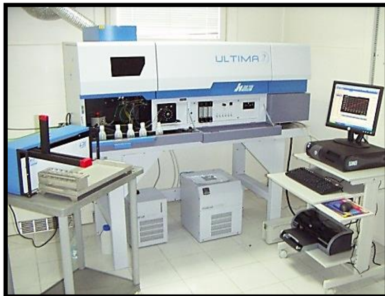
Figure II. 15 Spectrométrie d'Émission Atomique ICP Ultima2 Jobin Yvon
