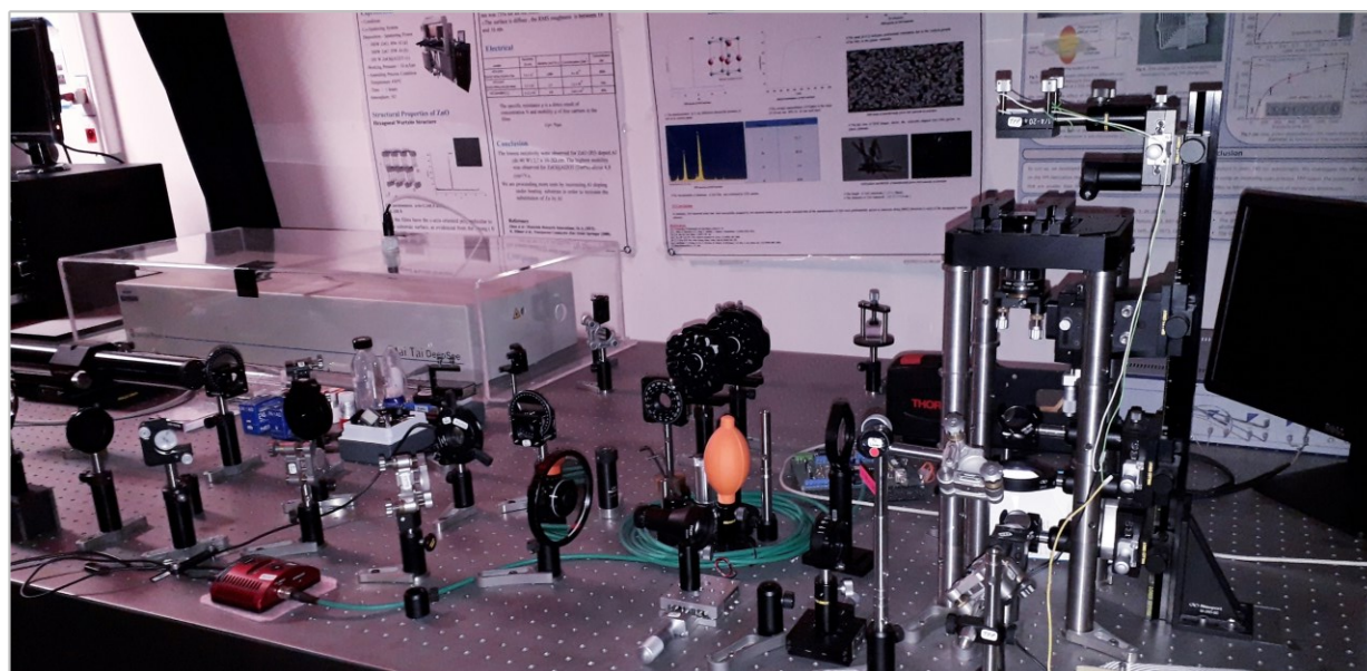
Fig. Système optique de la micro/nanofabrication 3D par l'absorption à deux photons.
