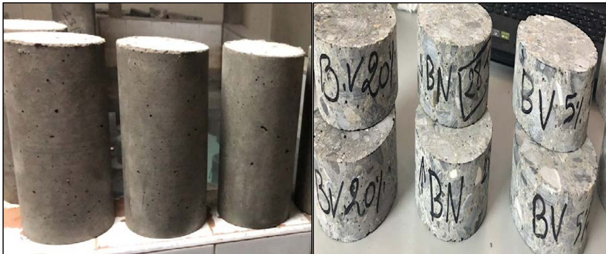
Figure 3.5 : cylindres destinés pour la compression ,porosité et la diffusion.
