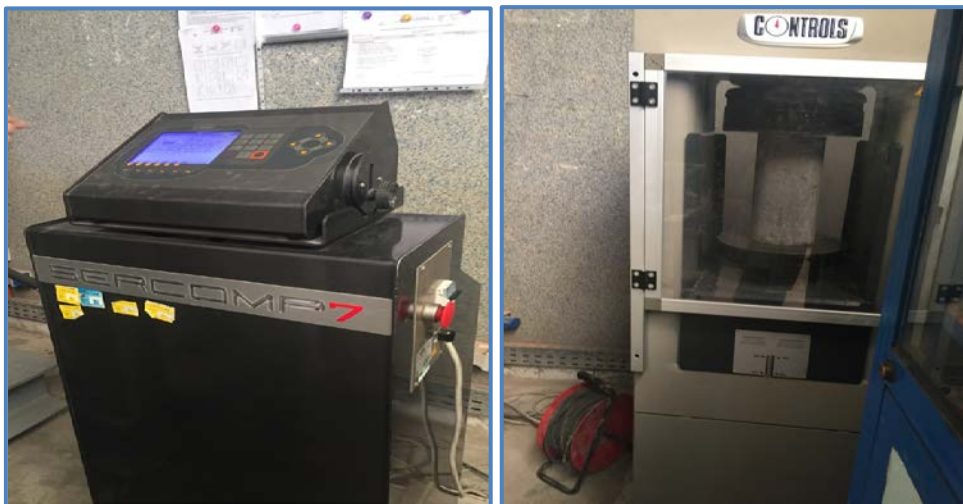
Figure 3.15 : test de résistance à la compression pour les cylindres du béton (LPEE Casablanca)
