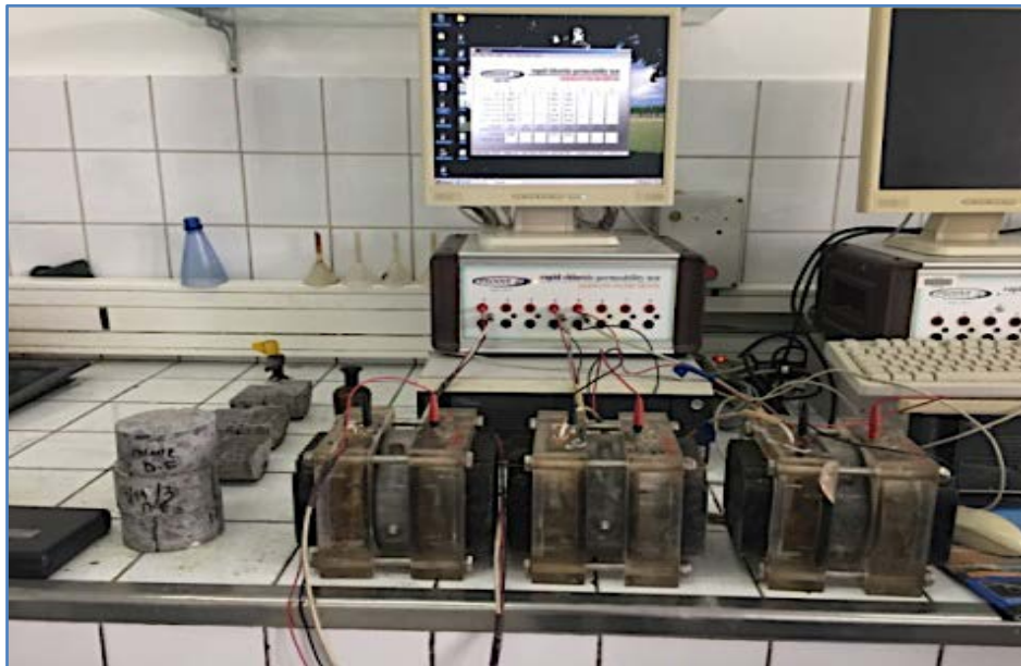
Figure 3.11 : Appareil pour mesurer la diffusion de chlorure « au Laboratoire du béton LPEE Casablanca- Maroc».
