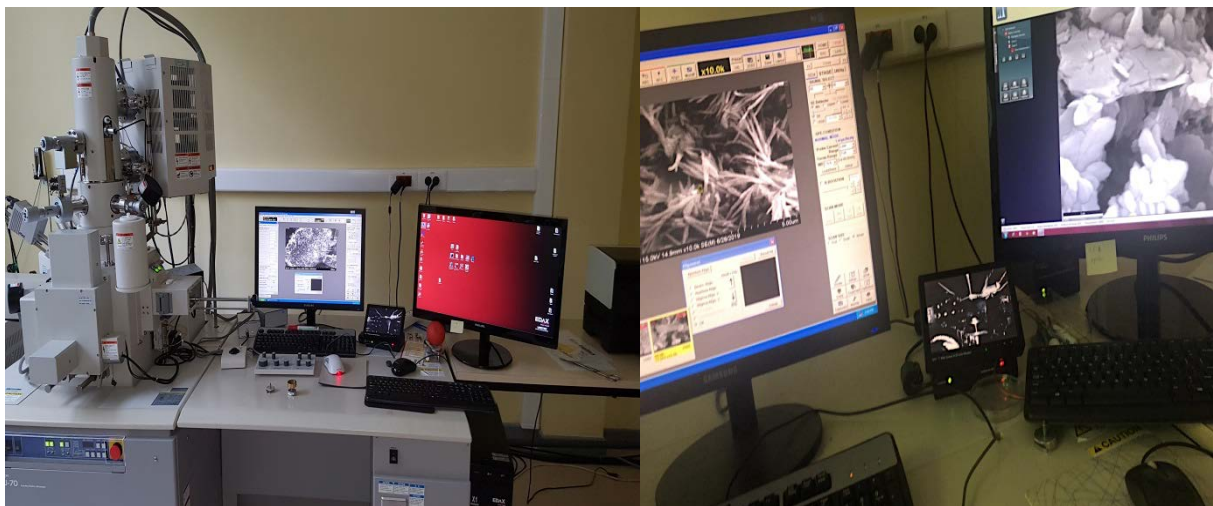
Figure 3.8 : Hitachi SU 70 appareil pour mesurer MEB avec EDX « au Laboratoire 4MAT ULB (Materials Engineering, characterization, synthesis and recycling) école polytechnique de bruxelles ULB Université libre de Bruxelles ».
