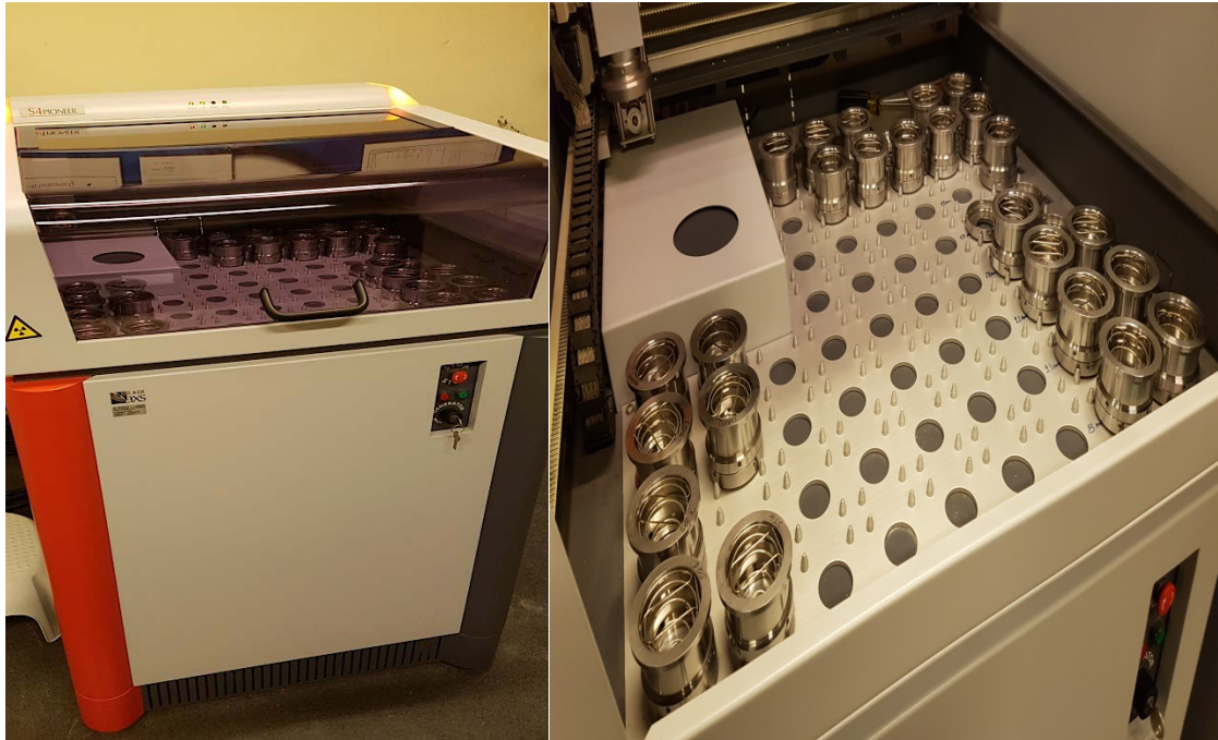
Figure 3.10 : D8 TIGER appareil pour mesurer XRF « au Laboratoire 4MAT ULB (Materials Engineering, characterization, synthesis and recycling) école polytechnique de bruxelles ULB Université libre de Bruxelles ».
