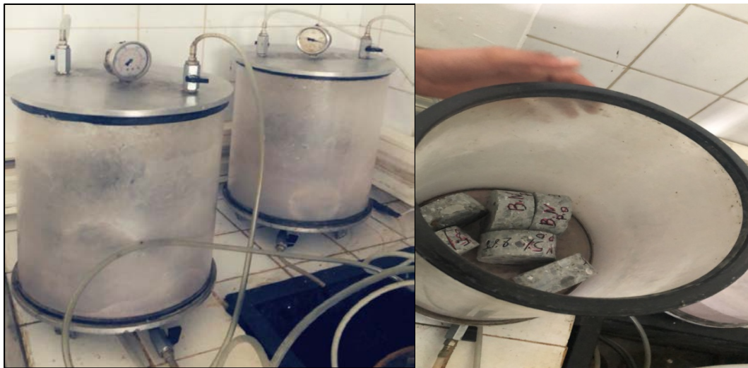
Figure. 3.16: test de Porosité (LPEE Casablanca)
