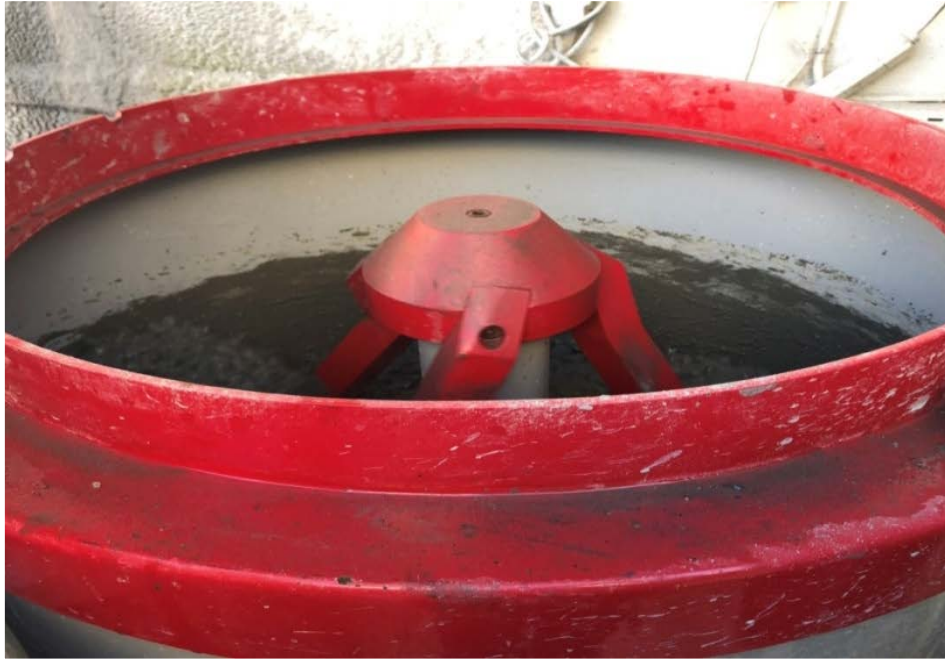
Figure 3.2 : Le malaxage des différents constituants d'un béton (LPEE Casablanca)
