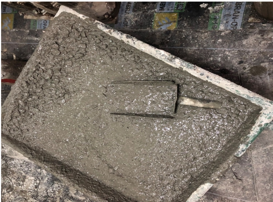
Figure 3.3 : la pâte du béton récupéré (LPEE Casablanca)
