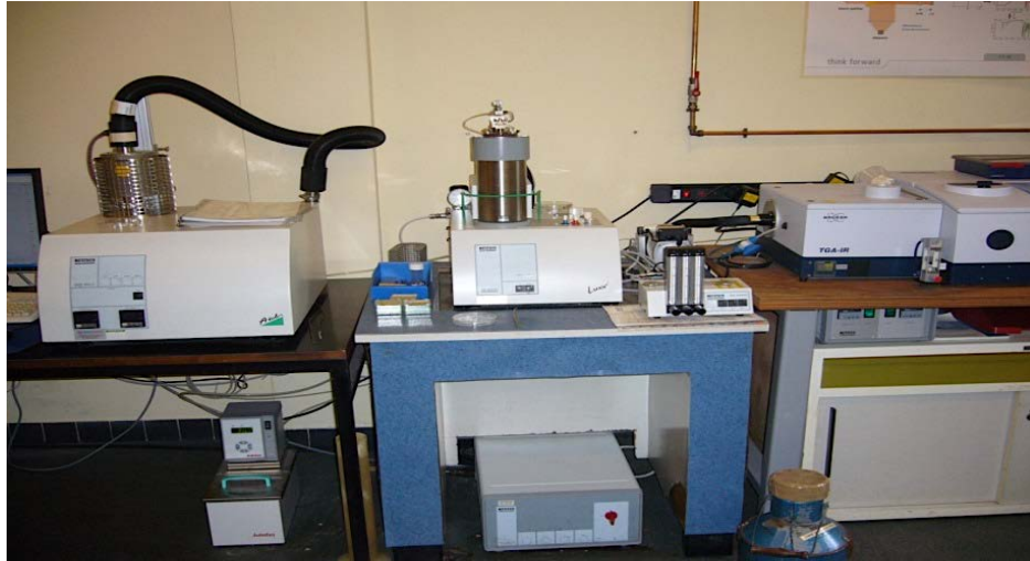
Figure 3.12 : Netzsch TG – DTA . DSC appareil « au Laboratoire des matériaux faculty of engineering vrije université de bruxelles VUB ».
