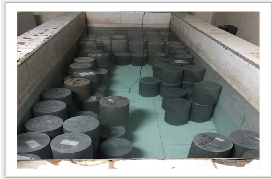
Figure 3.4 : Échantillonnage de béton dans les bains d'eau pour 28 jours. (LPEE Casablanca)
