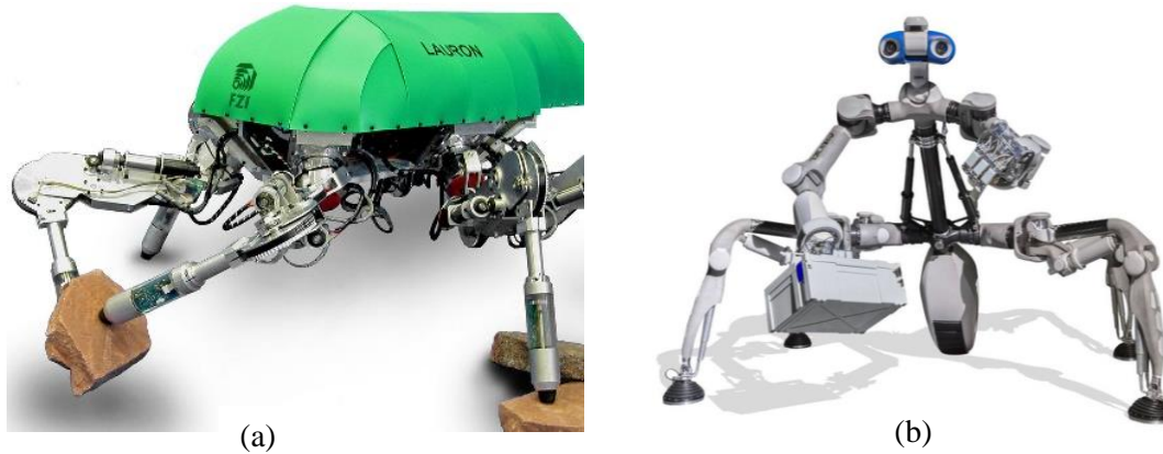
Figure 2.1: a) le robot LAURON V [27]. b) le robot MANTIS [28].
