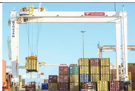
Figure 15 : Exemple d'une YCC
