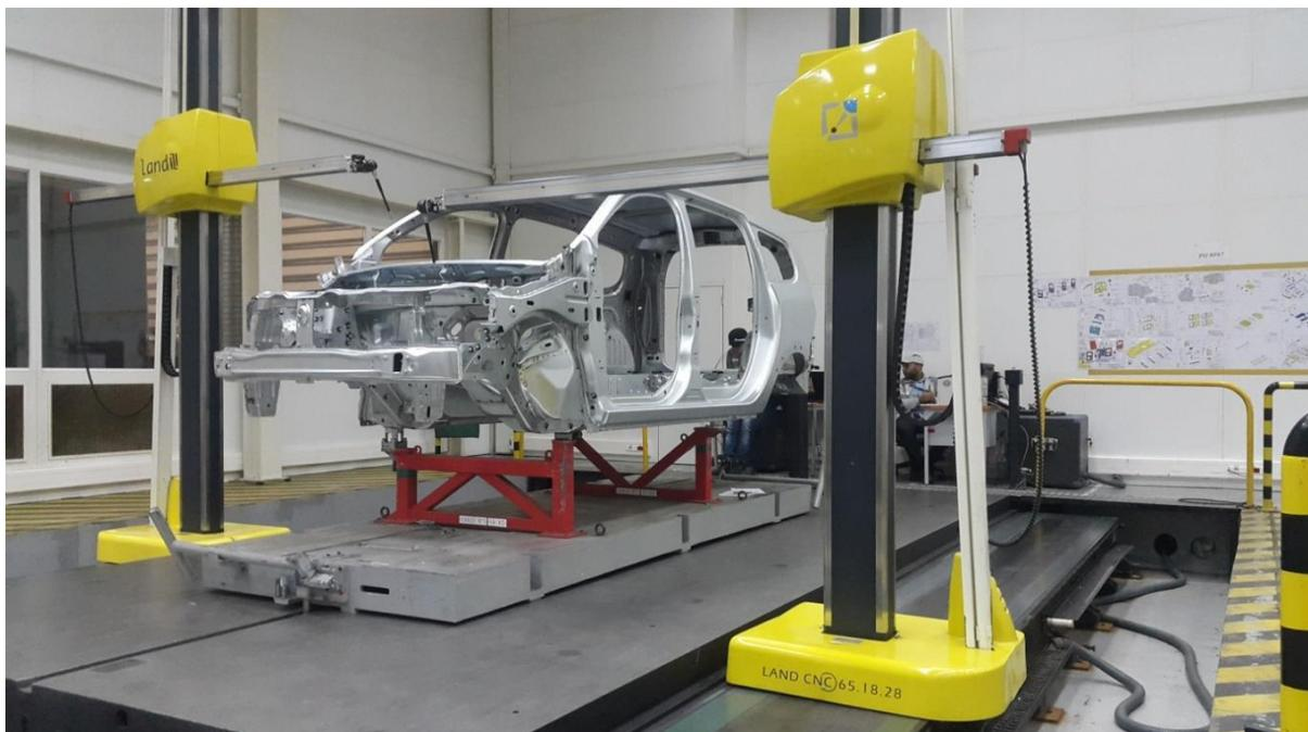
Figure 63: Contrôle 3D de la caisse assemblée
