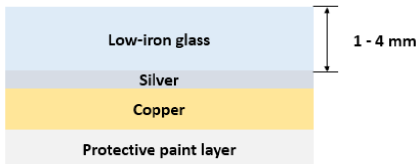
Fig. 2.16. Verre argenté de deuxième surface
