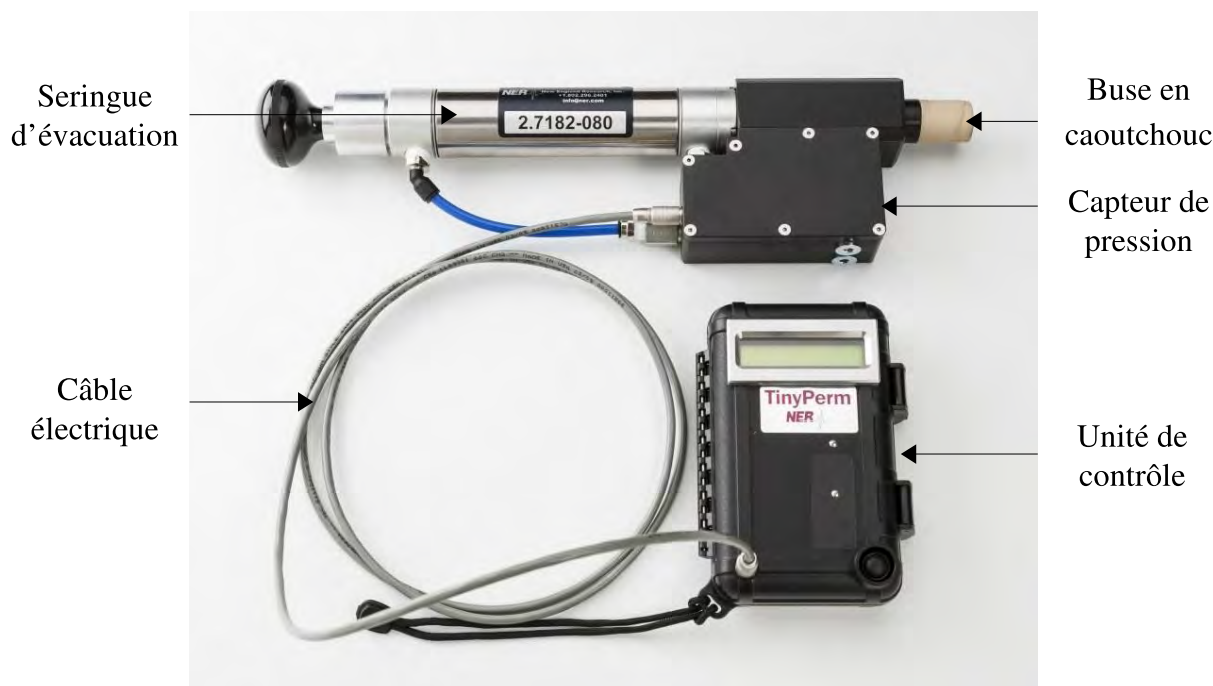
Figure 3.6 – Le perméamètre à air TinyPerm II.
