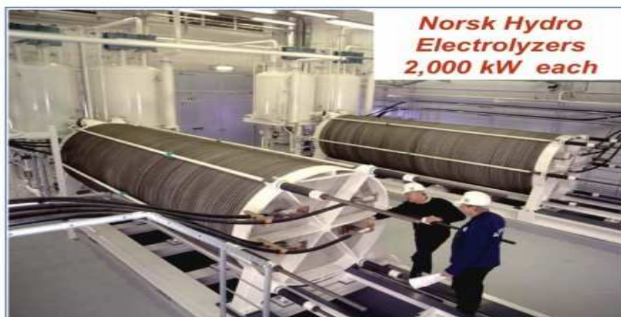
FIGURE 1.4 – Production de l’hydrogène à l’échelle de Mégawatt par Electrolyse (Source : Norsk Hydro)
