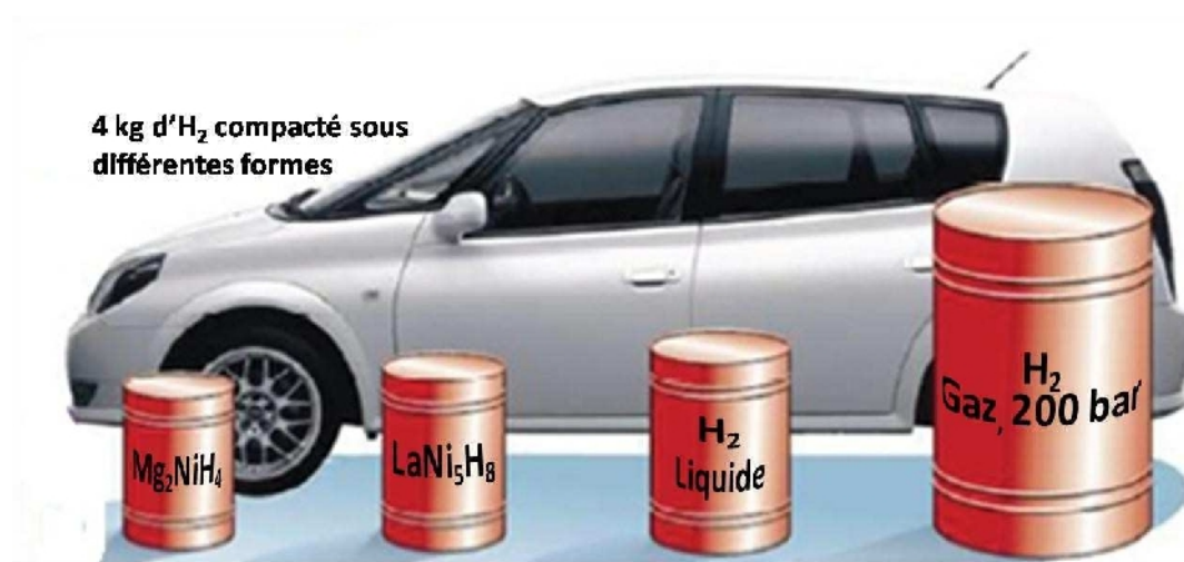
FIGURE 1.1 – Stockage de l'hydrogène dans des réservoirs. Volume de 4 Kg d'hydrogène comprimé dans différentes méthodes, avec la taille relative d'une voiture [9]
