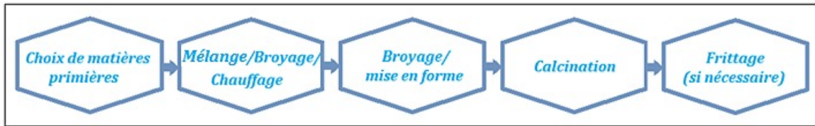
Figure-I.9. Quelques étapes de synthèse de poudre céramique.
