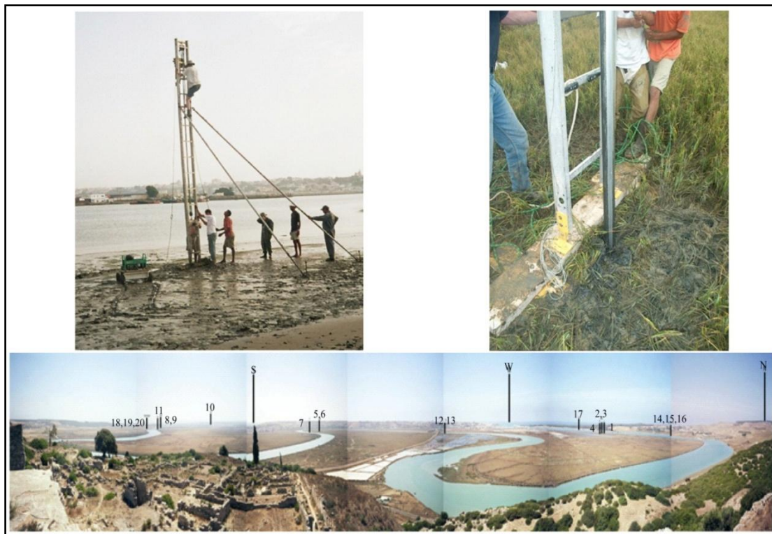
Figure 29 : photos du vibrocarottier de l'Université de Bordeaux et vue panoramique de l'emplacement des carottes CARLA dans le cadre du projet CARLA (Aloussi 2008)
