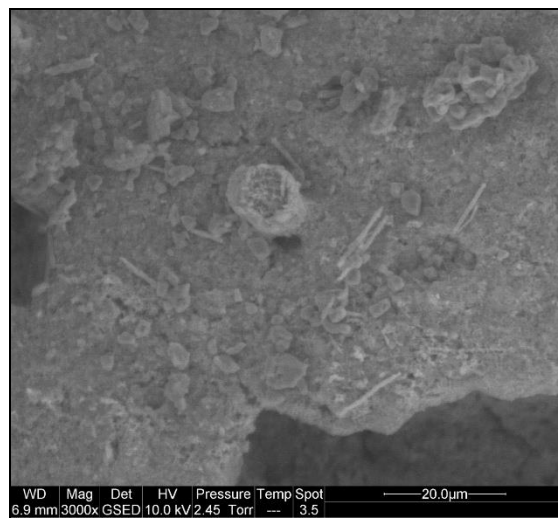
Fig. 6.6 : Photo par MEB d'échantillon d'enduit (EBCh).
