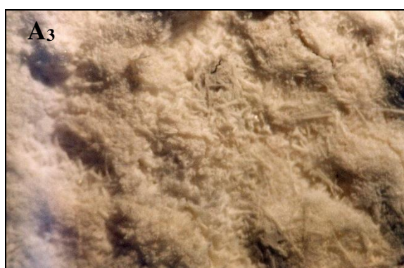
Fig.5.7.2- Observation des roches traitées (A 3 et B 3 ) par attaque l'acide sulfurique à l'œil nu (a) et (b), et par la loupe binoculaire (A 3 et B 3 ).
