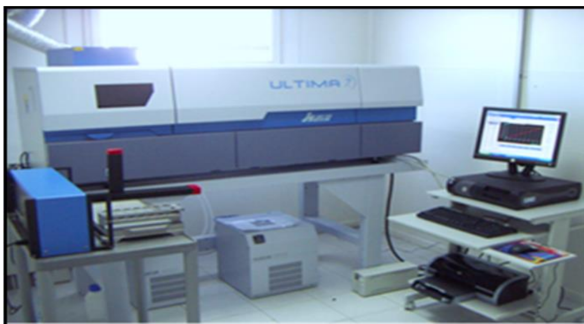
Figure I.1 : Appareil d'absorption atomique, Jobin Yvon Ultima 2
