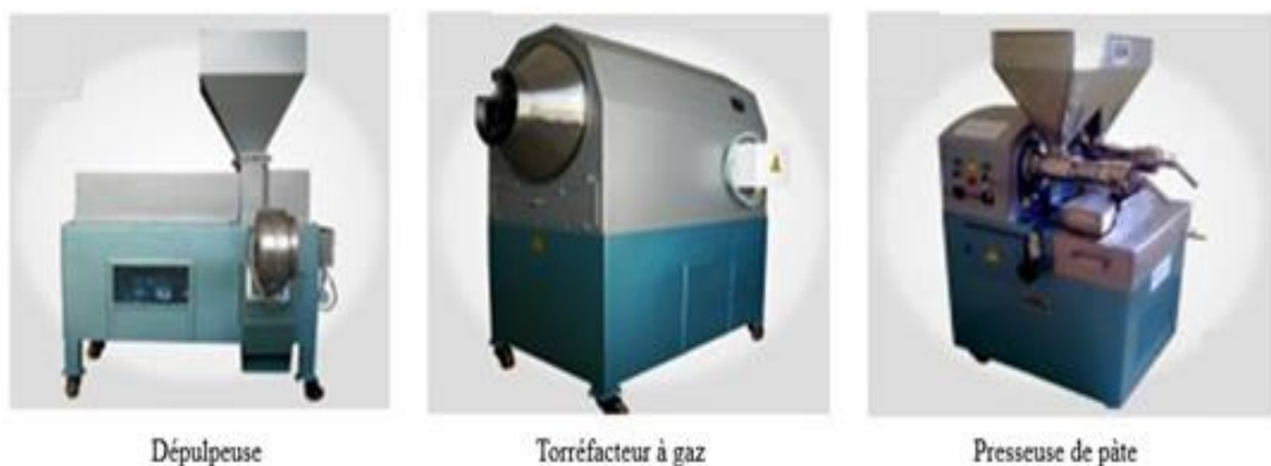
Figure I.5 : Machines utilisées pour l'extraction par presse mécanique de l'huile d'argan.
