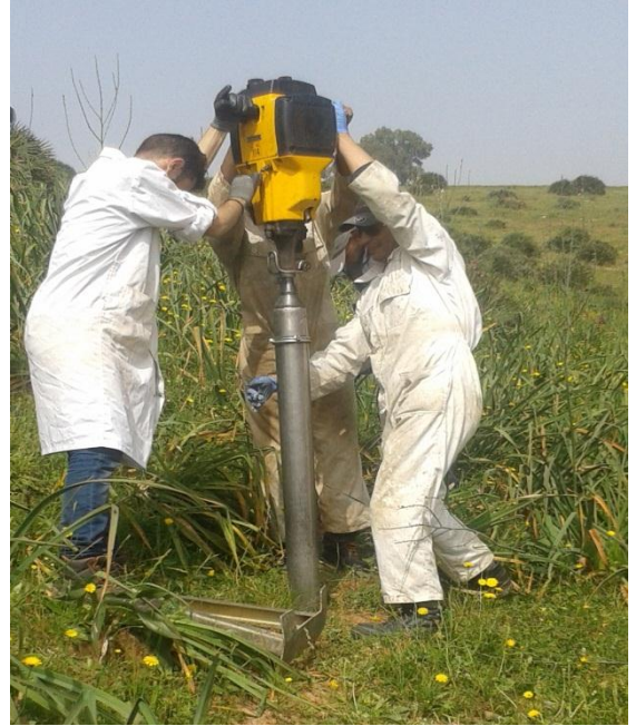
الصورة 28: أخذ العينة بواسطة moteur carottier
