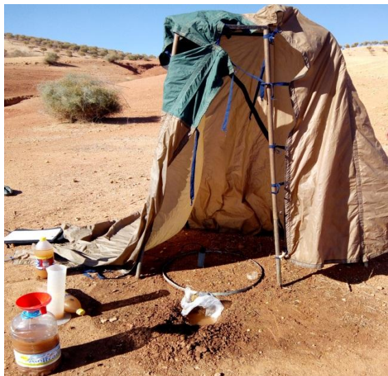
الصورة 34: قياسات تكميم التعرية باستعمال المقلد المطري
