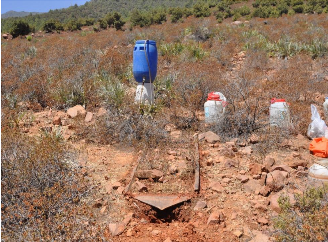
Photo 2 :Dispositif utilisé pour la simulation de pluie
