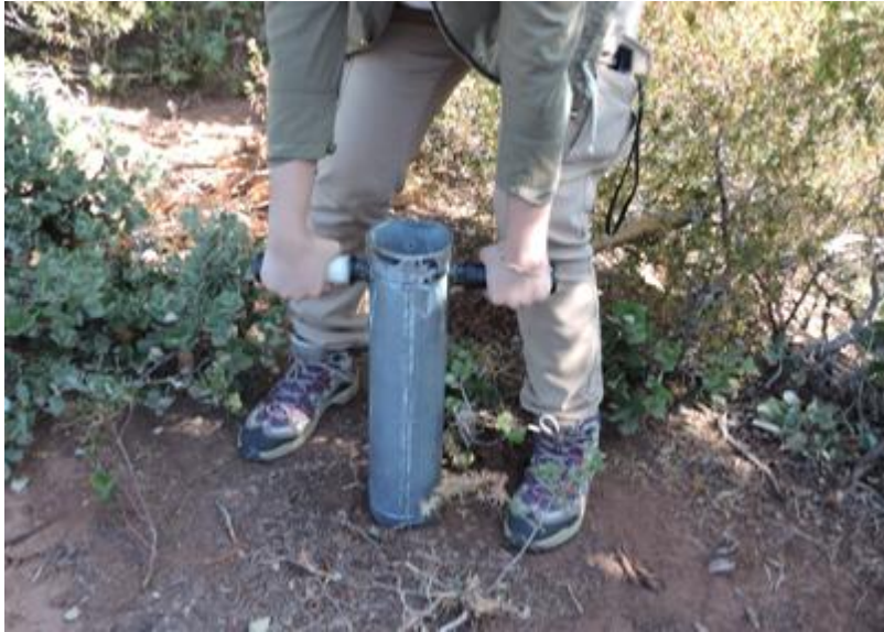
Photo 3 : Matériel de prélèvement des échantillons du sol
