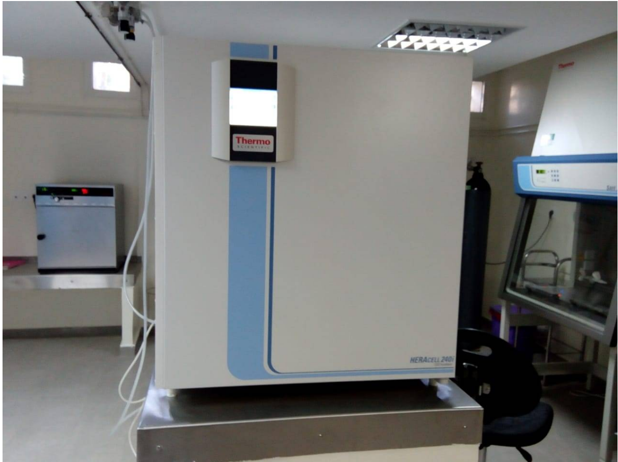
Photo 3: Incubateur à CO 2 au niveau d'une salle technique du laboratoire AMP
