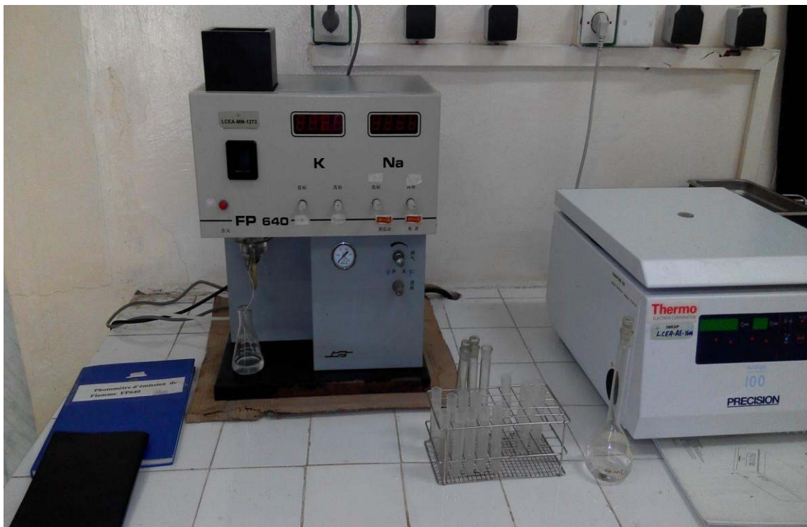
Planche 5: photomètre à flamme (LCEA-MM-1273).
