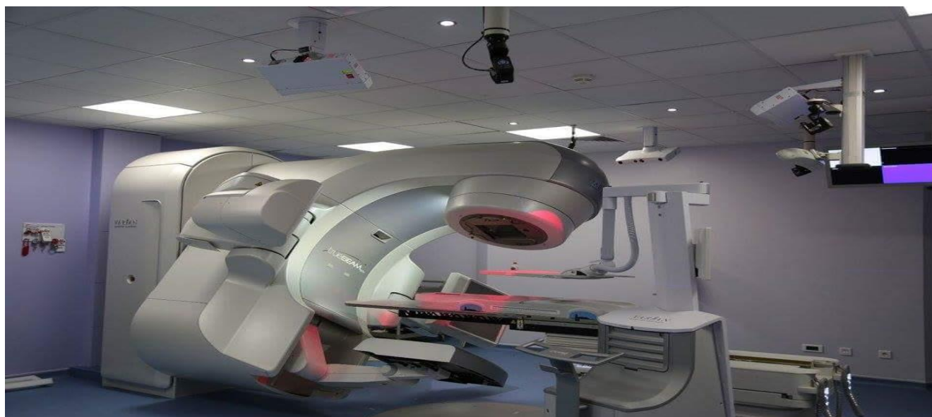
Figure I.7. Accélérateur linéaire équipé d'un imageur portal à haute énergie (MV EPID) et de l'imagerie embarquée OBI.
