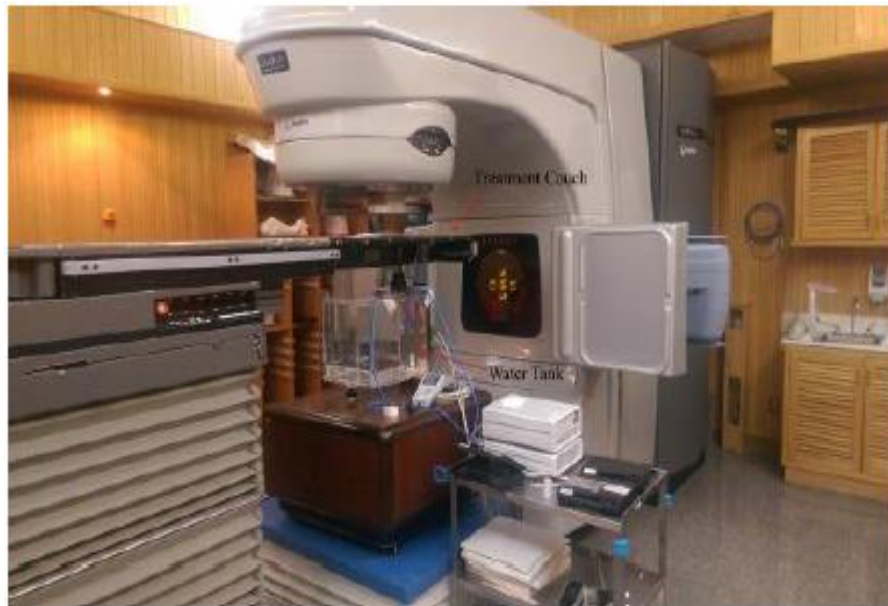
Figure IV.3 Mise en place de la cuve d'eau
