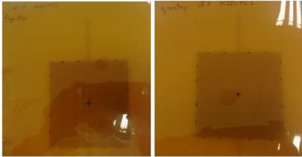
Figure IV.2 Coincidence du champ lumineux et du champ de rayon X
