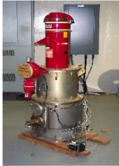
Figure II.20. Le klystron d'un accélérateur linéaire
