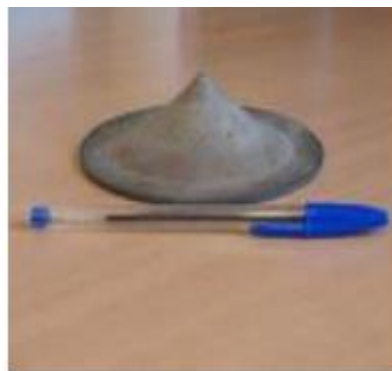
Figure II.23. Le cône égalisateur
