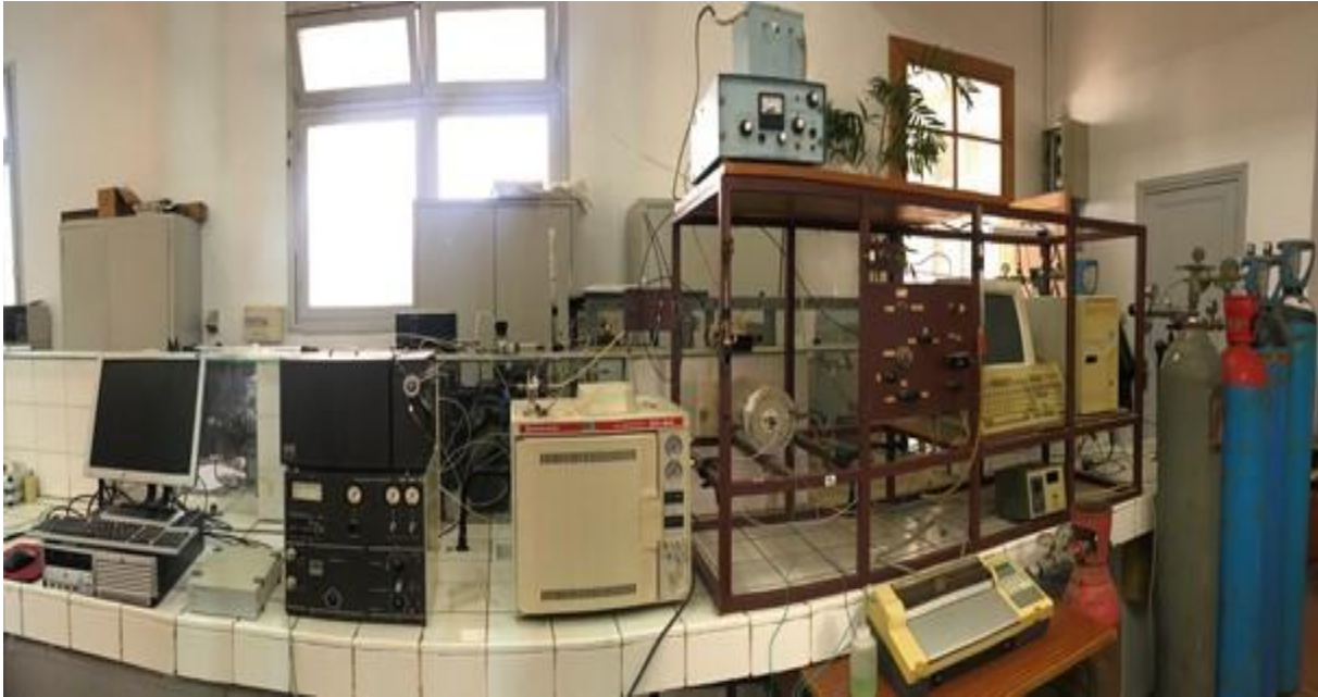
Figure 2-2. Dispositif expérimental de la réaction de reformage à sec du méthane en lit fixe.
