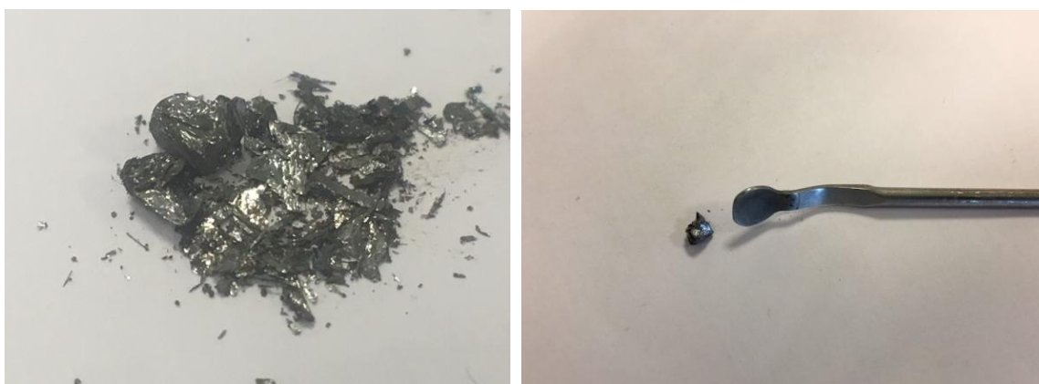
Figure 61: Photographes du phosphore noir récupéré en utilisant une quantité de Cu de 22,75mg.
