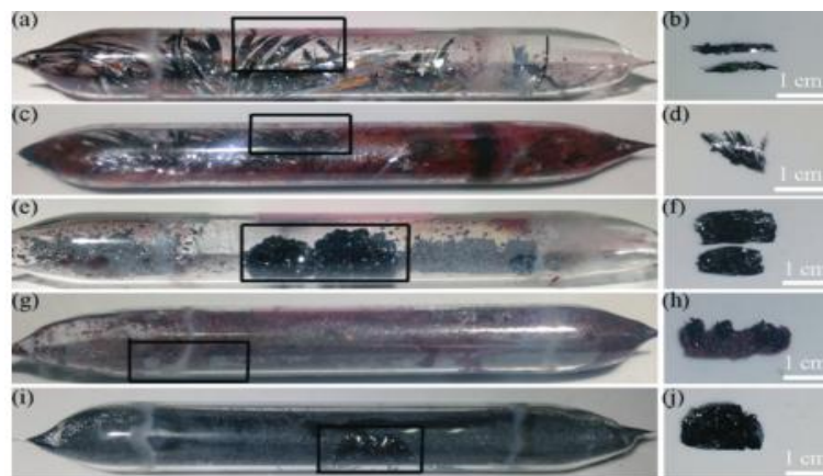
Figure 31: a, c, e, g, i) Photos des ampoules de silice avec les cristaux du phosphore noir synthétisé en utilisant RP@Sn@I 2 , RP@Pb@I 2 , RP@In@SnI 4 , RP@Cd@PbI 2 , RP@Bi@SnI 4 , respectivement ; (b, d, f, h, j) photos des cristaux du phosphore noir produits
