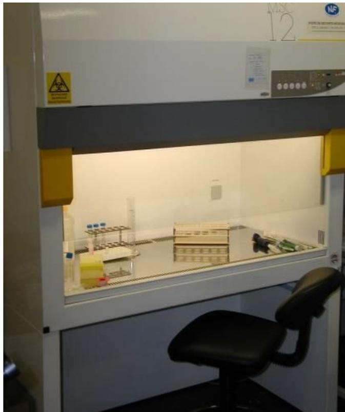
**Figure 28** : Hotte à flux laminaire vertical
