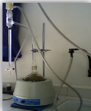
Figure II. 2: Montage utilisé pour l'extraction des huiles essentielles de la sauge Officinale par la méthode d'hydrodistillation.
