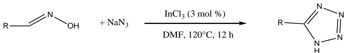
Schéma 35: Cycloaddition 1,3 dipolaire catalysée par \text{InCl}_3 35
