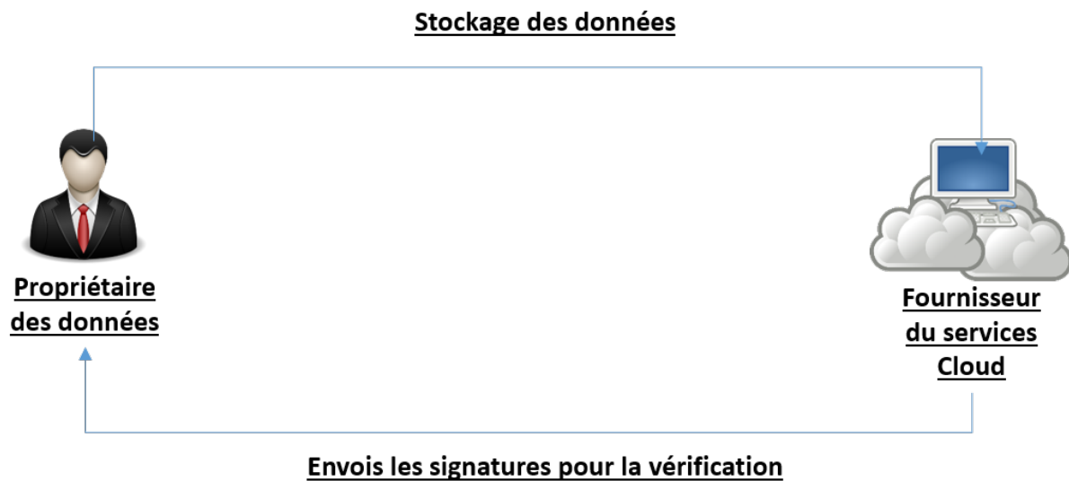
FIGURE II.11 – Vérification d'intégrité en utilisant des signatures pré-calculées.
