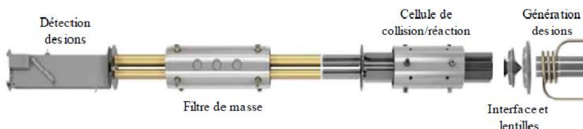
Figure 1.21 : Schéma général d'un ICP-MS quadripolaire
