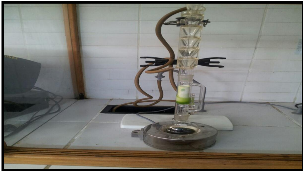
Figure 15: Montage expérimental de l'appareil Soxhlet
