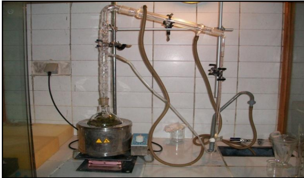
Figure 14: Montage expérimental d'hydrodistillation.
