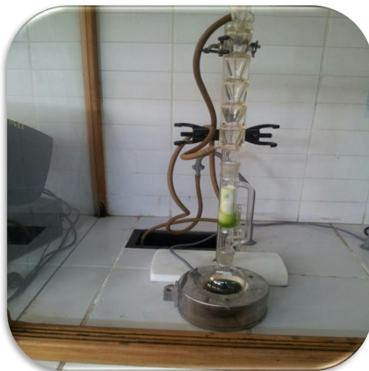
Figure 14 : montage expérimental de l'appareil soxhlet
