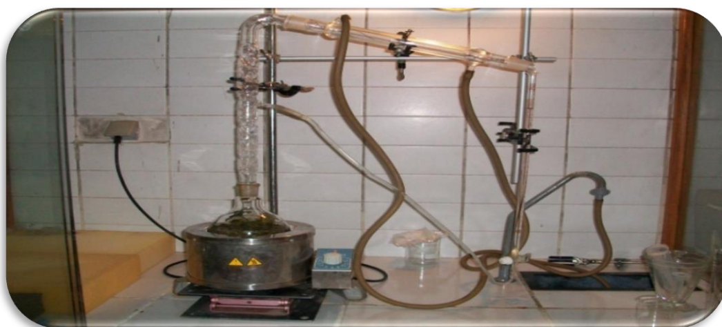
Figure 13 : Montage expérimental d'hydrodistillation
