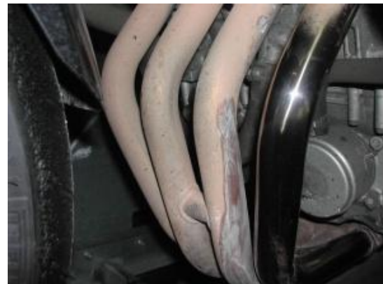
Figure I.2. : Mécanisme de la corrosion atmosphérique : exemple de la corrosion chimique d'un collecteur d'échappement.
