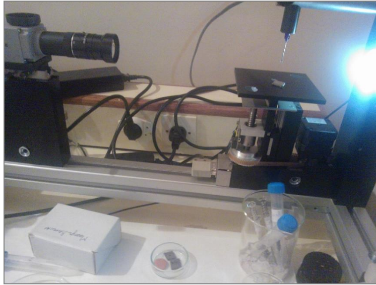
Figure 30 : Goniomètre (GBX, France) utilisé pour mesurer les angles de contact
