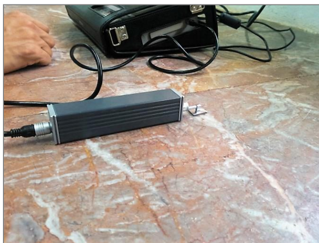
Figure 28 : Mesure de la rugosité des surfaces des alliages dentaires
