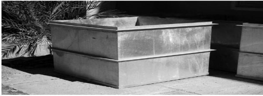
Photo 13: Bac d'évaporation cubique de 1 m d'arête utilisé dans la station météorologique d'Erfoud (05/06/2015)
