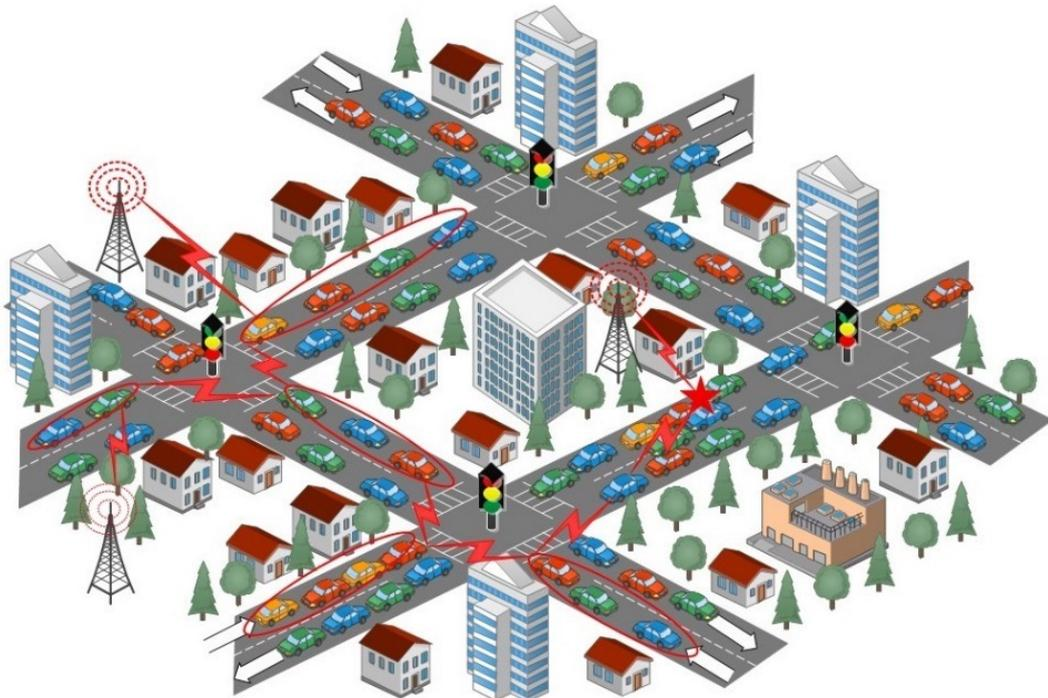
FIGURE 1.6 – Différentes architectures de communications dans les réseaux VANET : V2V, V2I et hybride
