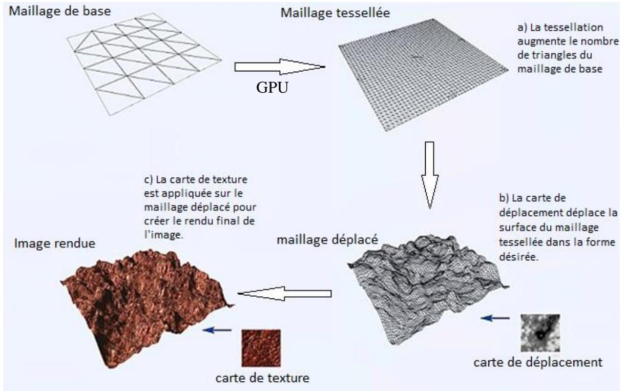
**Figure 4-11 : Exemple de l'utilisation de tessellation matérielle pour le rendu d'une surface avec des petites reliefs.**
