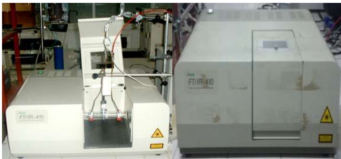
Figure 19: Spectrophotomètre infrarouge à transformé de fourrier de type Jasco-410.
