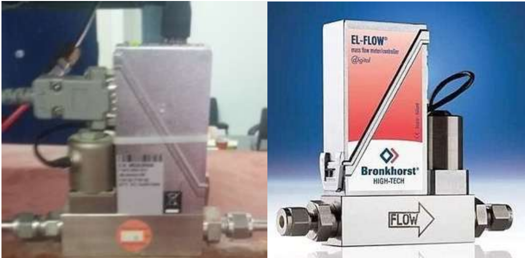
Figure 16: Photo de débitmètres massiques (Bronkhorst).
