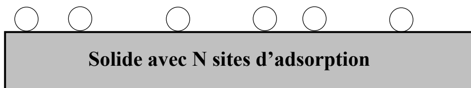
Figure 3: Modèle d'adsorption en monocouche.
