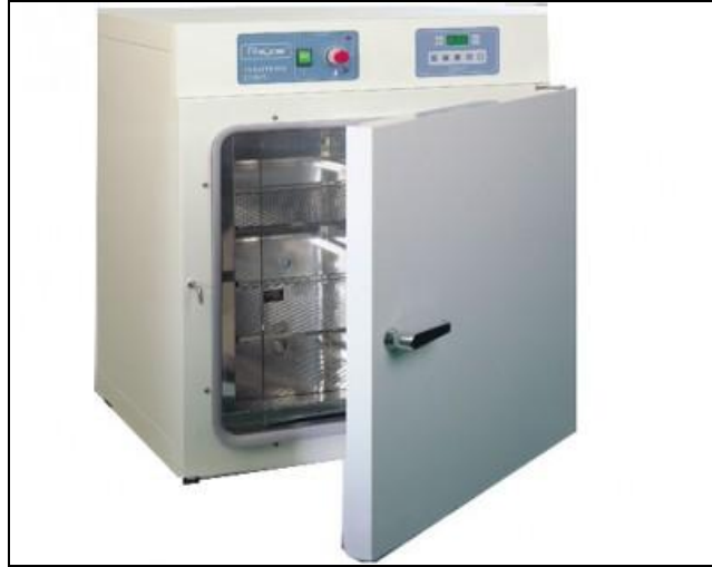
Figure 8. Photo de la chambre de culture (Heraeus) utilisée pour la culture et la multiplication des cellules HeLa.
