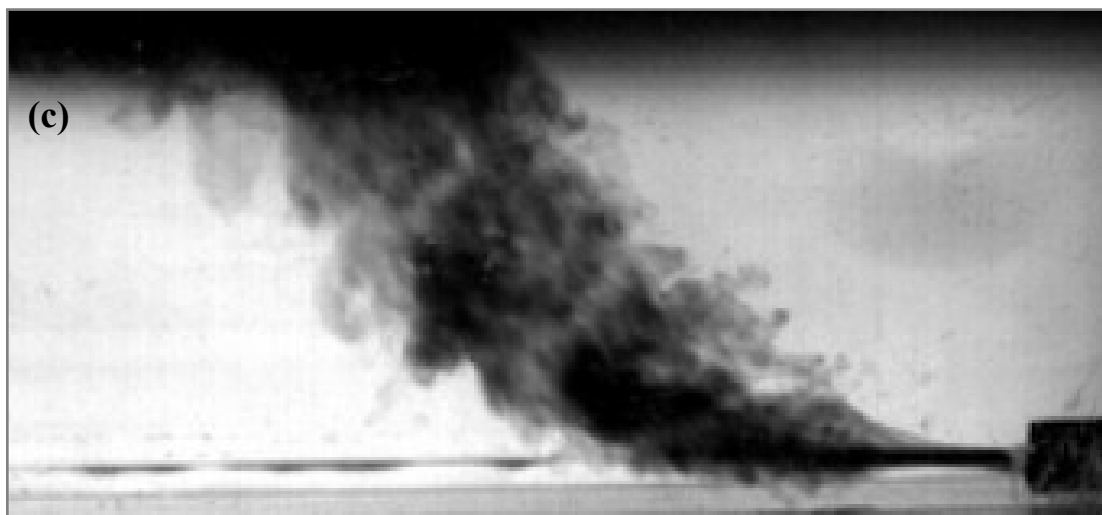
Fig. IV.8. Photos de l'écoulement laminaire du jet de l'eau douce dans la cuve de l'eau salée:
