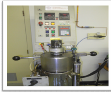
Figure 17. Equipement des hautes pressions hydrostatiques.
