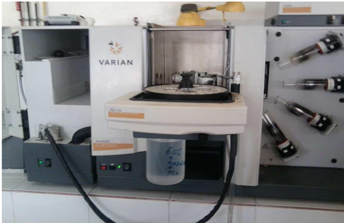
Figure II-4 : Image d'un appareillage de la spectroscopie d'absorption atomique utilisé
