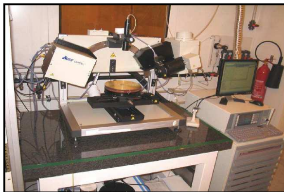
Figure 20. L'ellipsomètre à modulation de phase Jobin-Yvon UVISEL du laboratoire LTM-Grenoble
