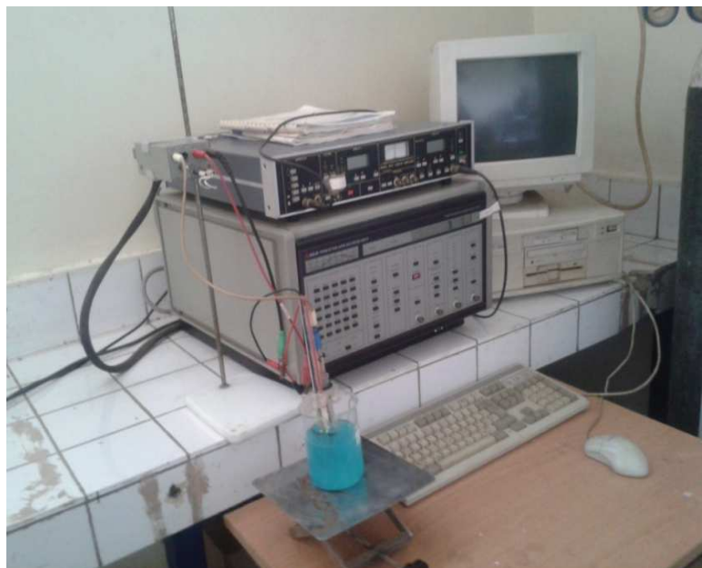
Figure II.5: Schéma de principe du dépôt électrochimique par un dispositif classique à trois électrodes
