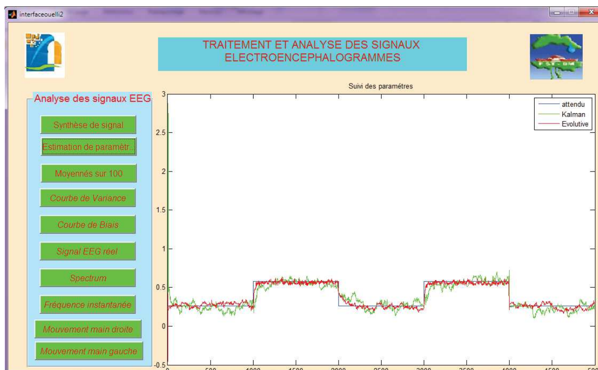
Figure A-16 : estimation des paramètres du signal synthétique par le filtre de Kalman et par la méthode proposée.
