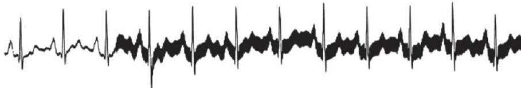
Figure 3-3 : Exemple d'ECG présentant des interférences 50Hz.
