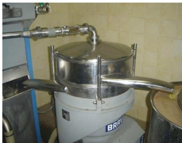
**Figure 4** : Centrifugeuse. A droite sortie de l'huile d'olive, à gauche sortie des margines
