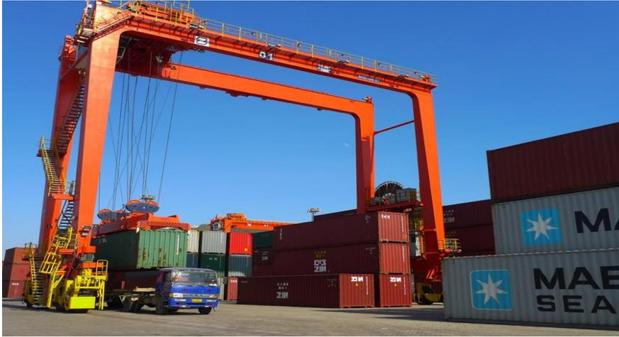
Figure 4: opération de manutention du RTG dans le port maritime
