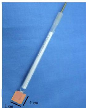
**Figure 17: Électrode de travail (plaque de cuivre).**
