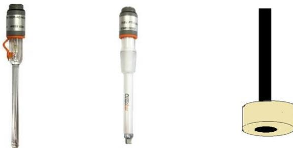
Electrode de référence      Electrode auxiliaire      Electrode de travail
